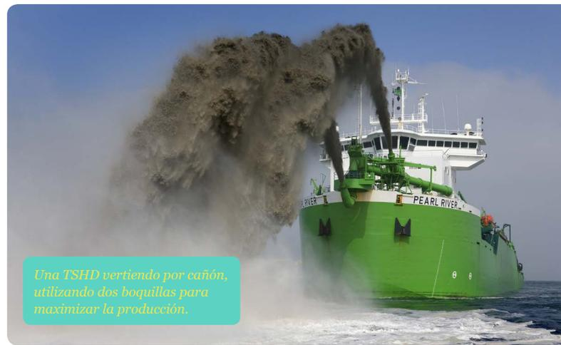
Una TSHD vertiendo por cañón, utilizando dos boquillas para maximizar la producción.
