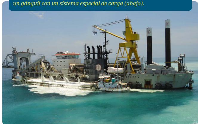
Las DSC pueden descargar el material dragado bien por medio de una tubería flotante hasta la costa (arriba) o bien descargándolo en un gánguil con un sistema especial de carga (abajo).
