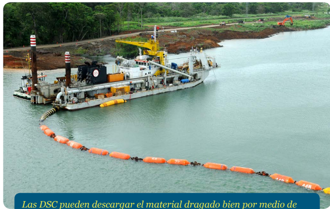
Las DSC pueden descargar el material dragado bien por medio de una tubería flotante hasta la costa (arriba) o bien descargándolo en un gánguil con un sistema especial de carga (abajo).
